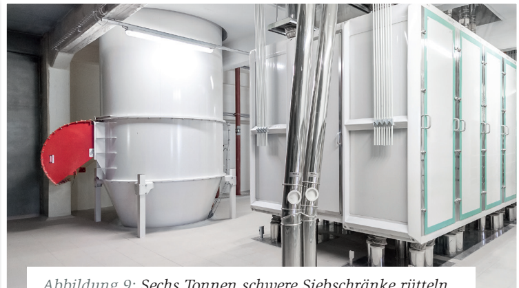
Abbildung 9: Sechs Tonnen schwere Siebschränke rütteln, um die verschiedenen Mahlfractionen zu trennen
